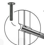
После установки всех секций наместо и их выравнивания сверлятся отверстия Ø8мм.
